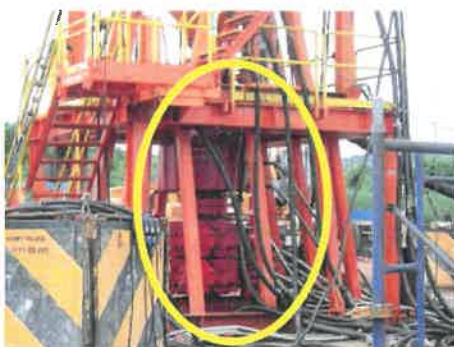
รูปที่ 2-47 อุปกรณ์ป้องกันการพลุ่ง (BOP)
